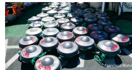
Boyas satelitales con ecosondas de DAP. Cada una va amarrada a un DAP y transmite información sobre los peces que se encuentran bajo el DAP así como su ubicación posicional.
